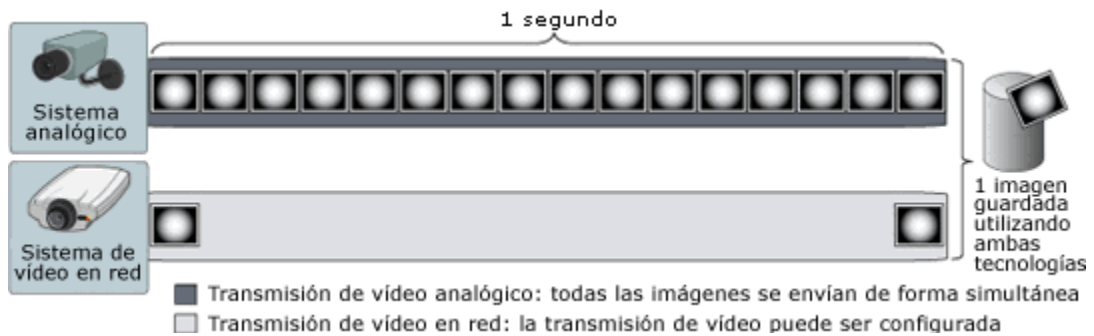
Figura 19. Transmisión de video analógico y en red
