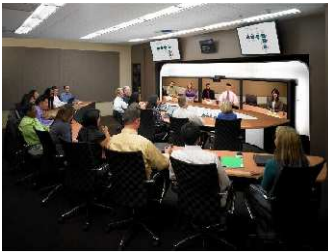
Figura 37. Equipo Cisco Telepresence System 3200
