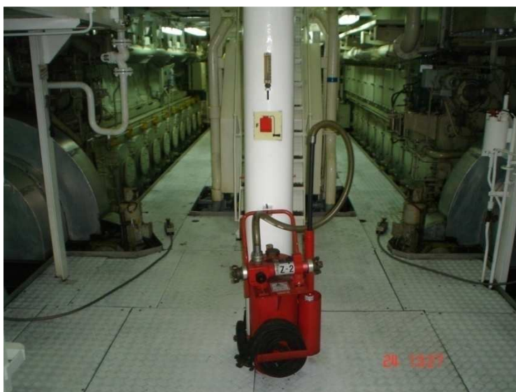
Fig. 3: Vista de los dos motores principales MAN, con el virador engranado para virar el motor
