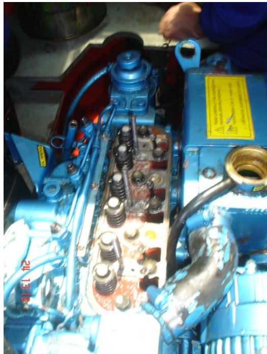
Fig. 38: Vista de las válvulas del motor propulsor del bote salvavidas del lado de estribor
