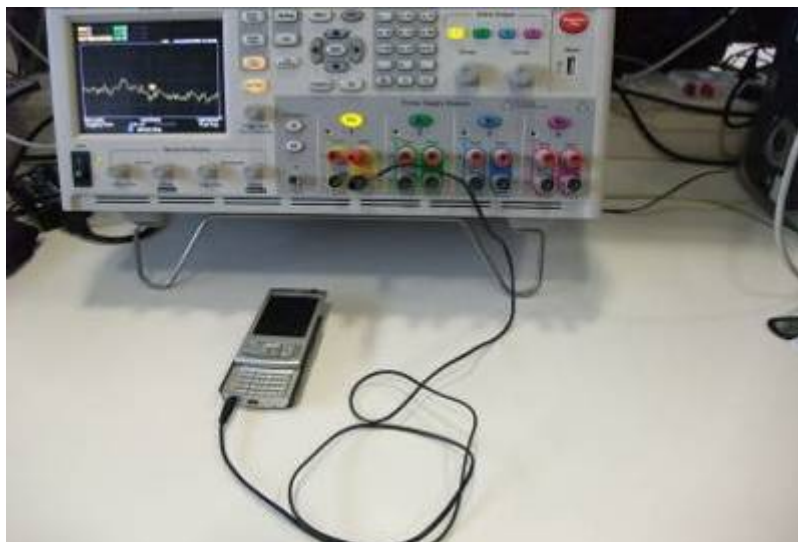
Fig V.29. Connexió de l'analitzador de potència Agilent N6705A a l'STA 4
