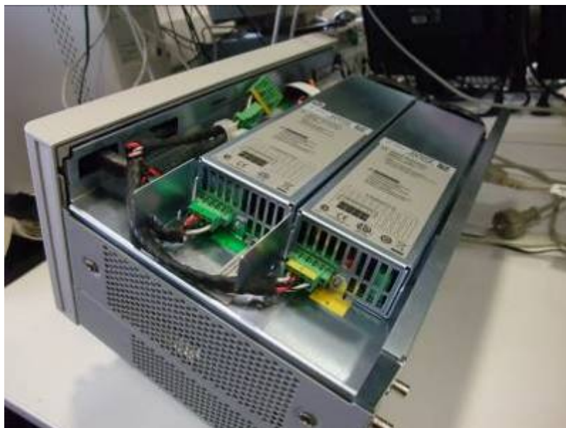
Fig. IV.5. Ubicació dels mòduls de potència
