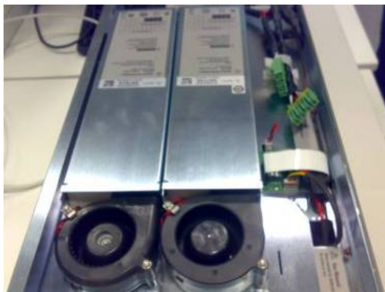
Fig. IV.2. Mòduls de potència de l'analitzador Agilent N6705A
