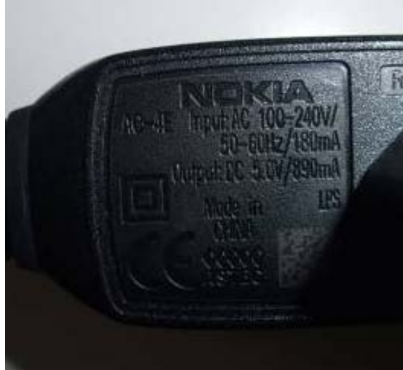
Fig V.23. Característiques elèctriques de l'STA 4
