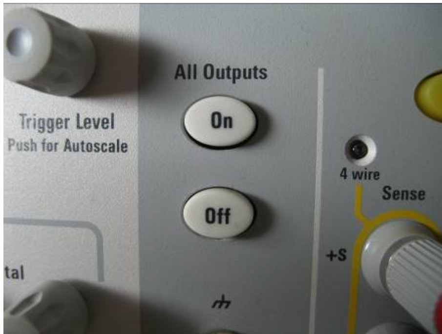
Fig IV.30. Sistema On / Off programable
