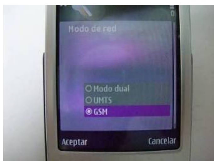
Fig V.25. Menú d'habilitació GSM/UMTS STA 4
