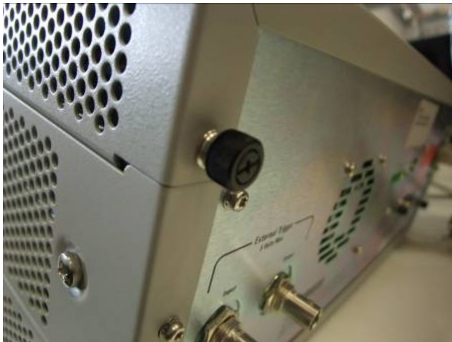
Fig. IV.3. Cargol de desencaix de la tapa superior de l'analitzador
