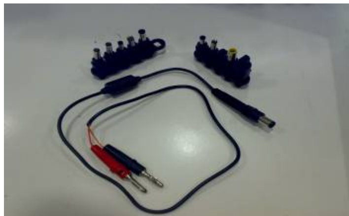
Fig. 4.2. Cable de connexió STA – analitzador multipunta
