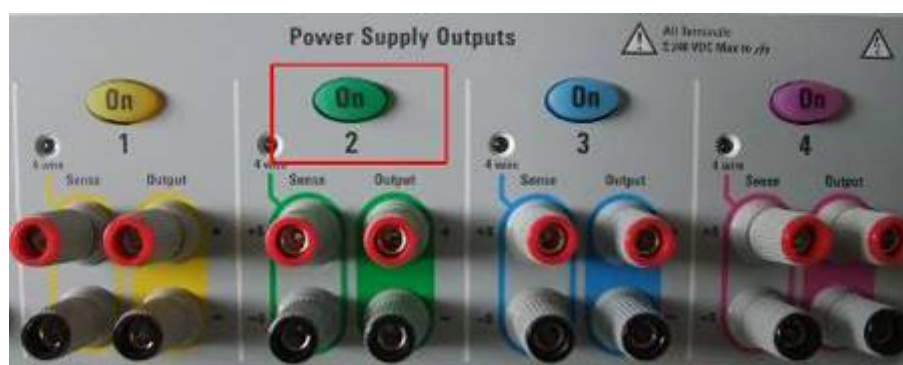
Fig. IV.16. Botó selector de la sortida d'alimentació 2
