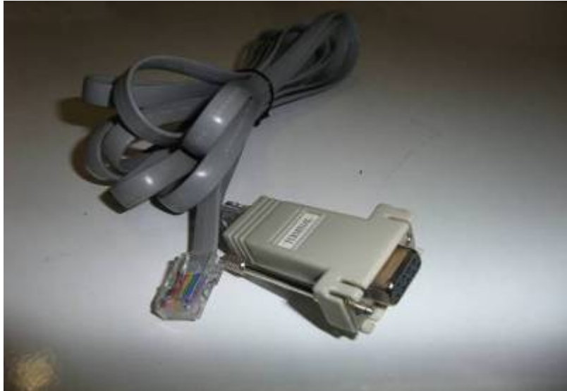
Figura V.3. Cable de consola DB-9 a RJ45
