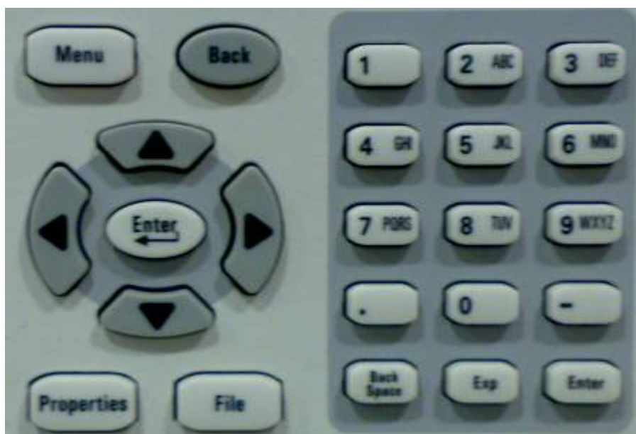
Fig. IV.13. Cursor i teclat numèric de l'analitzador de potència Agilent N6705A
