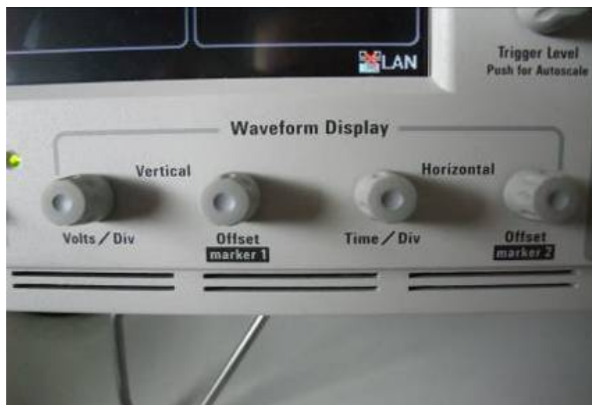
Fig. IV.24. Potenciòmetres d'ajustament de l'analitzador de potència
