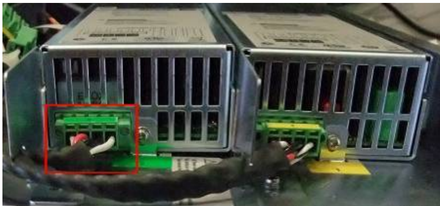
Fig. IV.6. Sòcol de connexió del mòdul de potència
