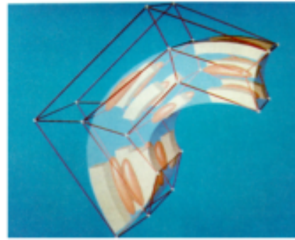
(d) The control points in a deformed position.
