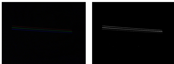
(a) Imatge filtrada fent la diferència entre la captura i el fons. (b) Imatge filtrada aplicant una binarització a E.3(a).
