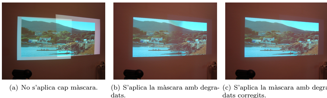
Figura E.6: Resultats obtinguts amb el procés de calibratge, aplicant diferents màscares per a la correcció cromàtica.
