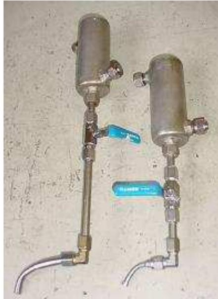
**Figura 17. Depósitos de aceite (BA20) y NaOH (BA30)**
