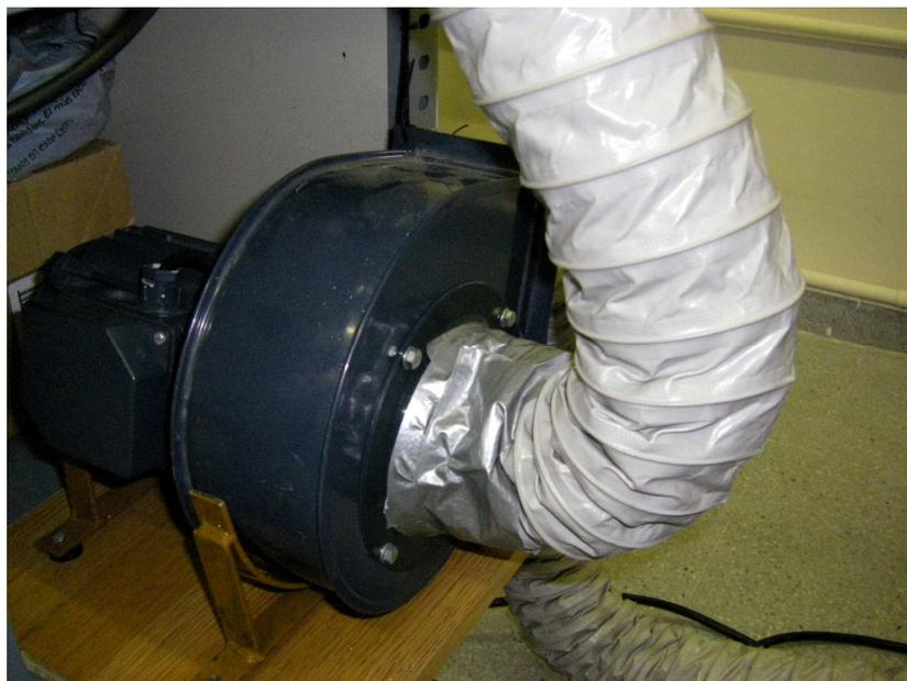
**Figura 29. Extractor de gases**
