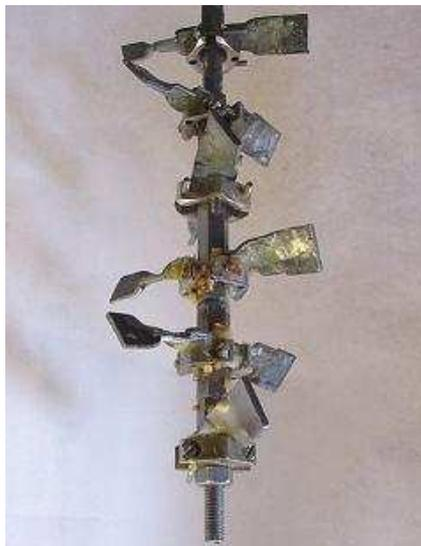
**Figura 97. Primera versión de las palas del agitador**
