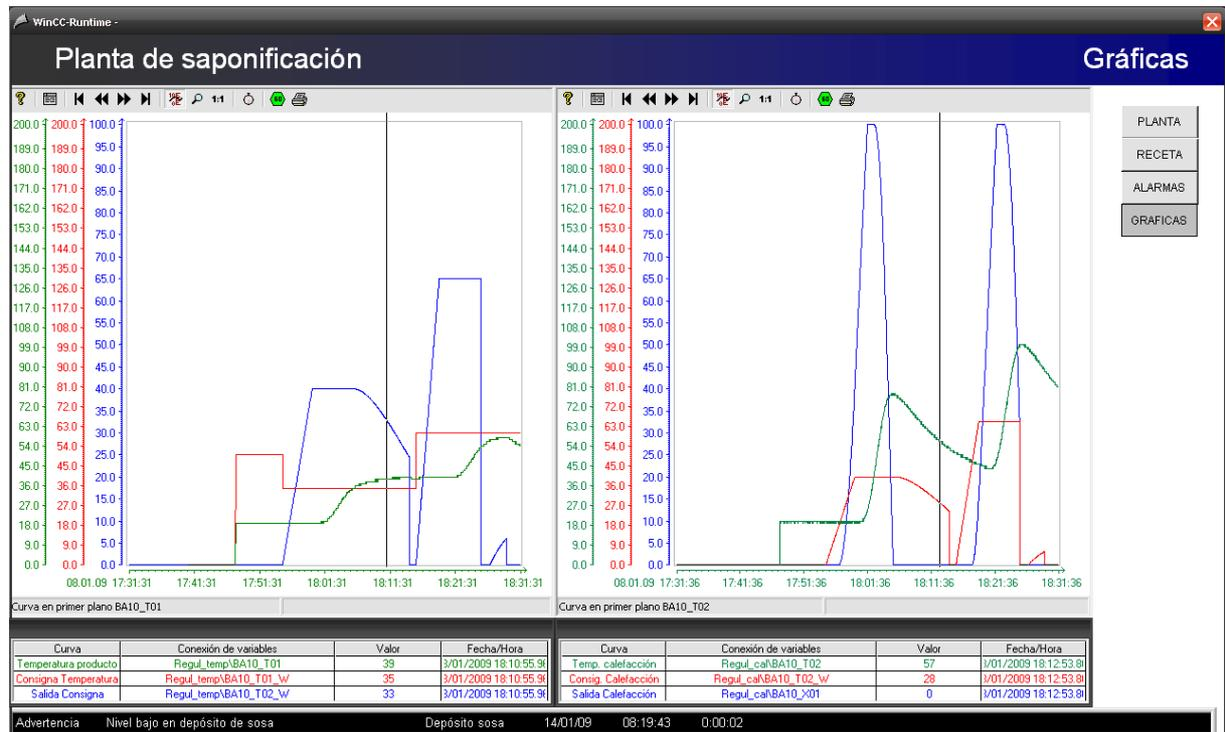
**Figura 96** Pantalla “Gráficas” con regulación con 2 PID en cascada
