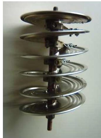
Figura 9 Palas del agitador
