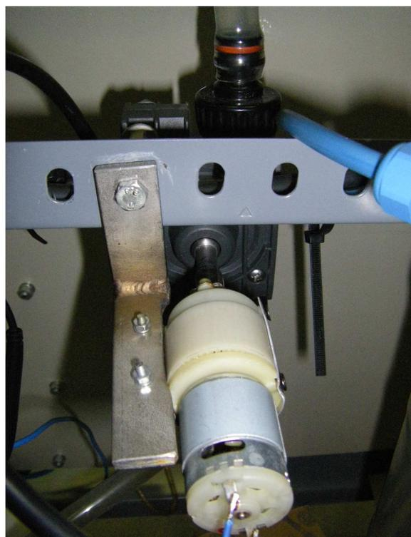
Figura 24. Motor de la bomba dosificadora
