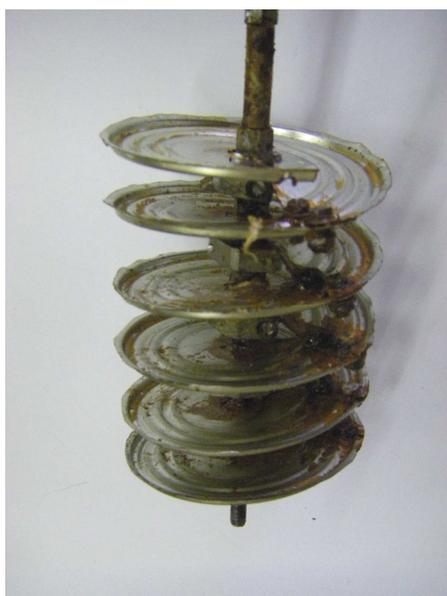
**Figura 98. Palas helicoidales del agitador**
