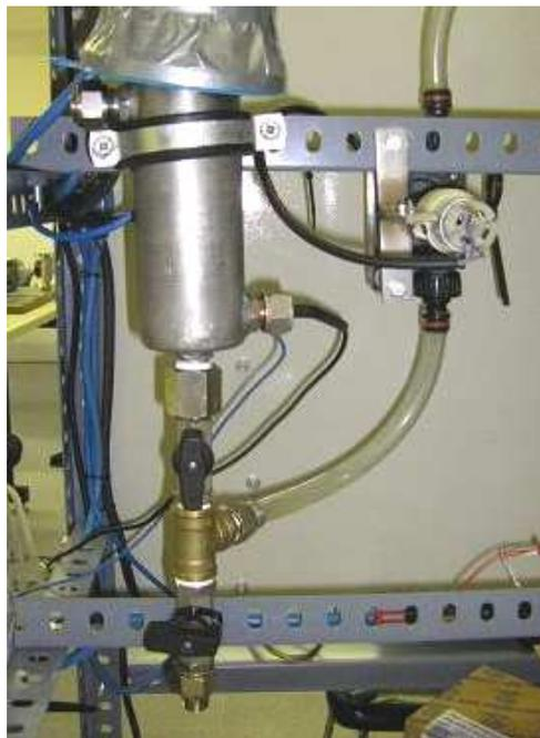
Figura 26. Juego de válvulas para purgar la instalación
