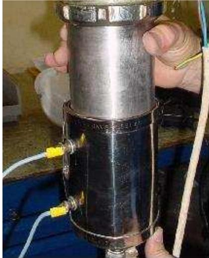
Figura 13 Resistencia calefacción
