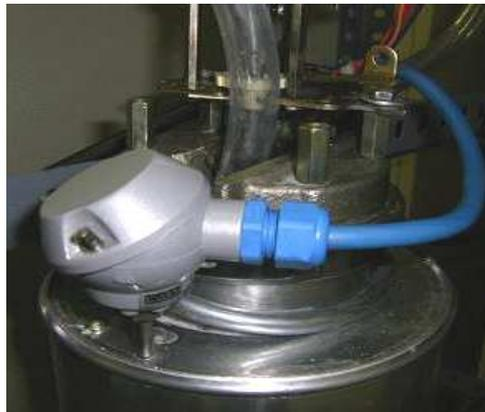
Figura 16 Sonda temperatura de calefacción insertada
