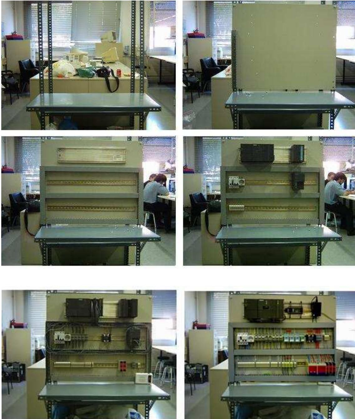
**Figura 48. Montaje del cuadro eléctrico**
