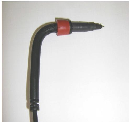
**Figura 105 Nivel del depósito NaOH construido con una punta de multímetro**
