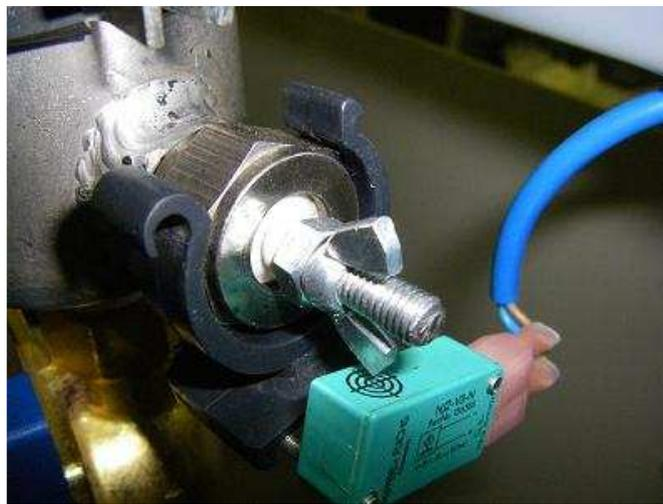
Figura 20. Nivel de boya instalado.
