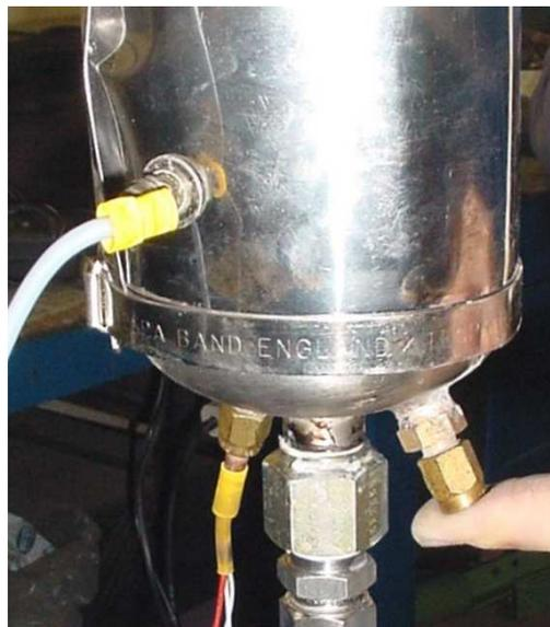
**Figura 12. Sonda de temperatura y calefacción**
