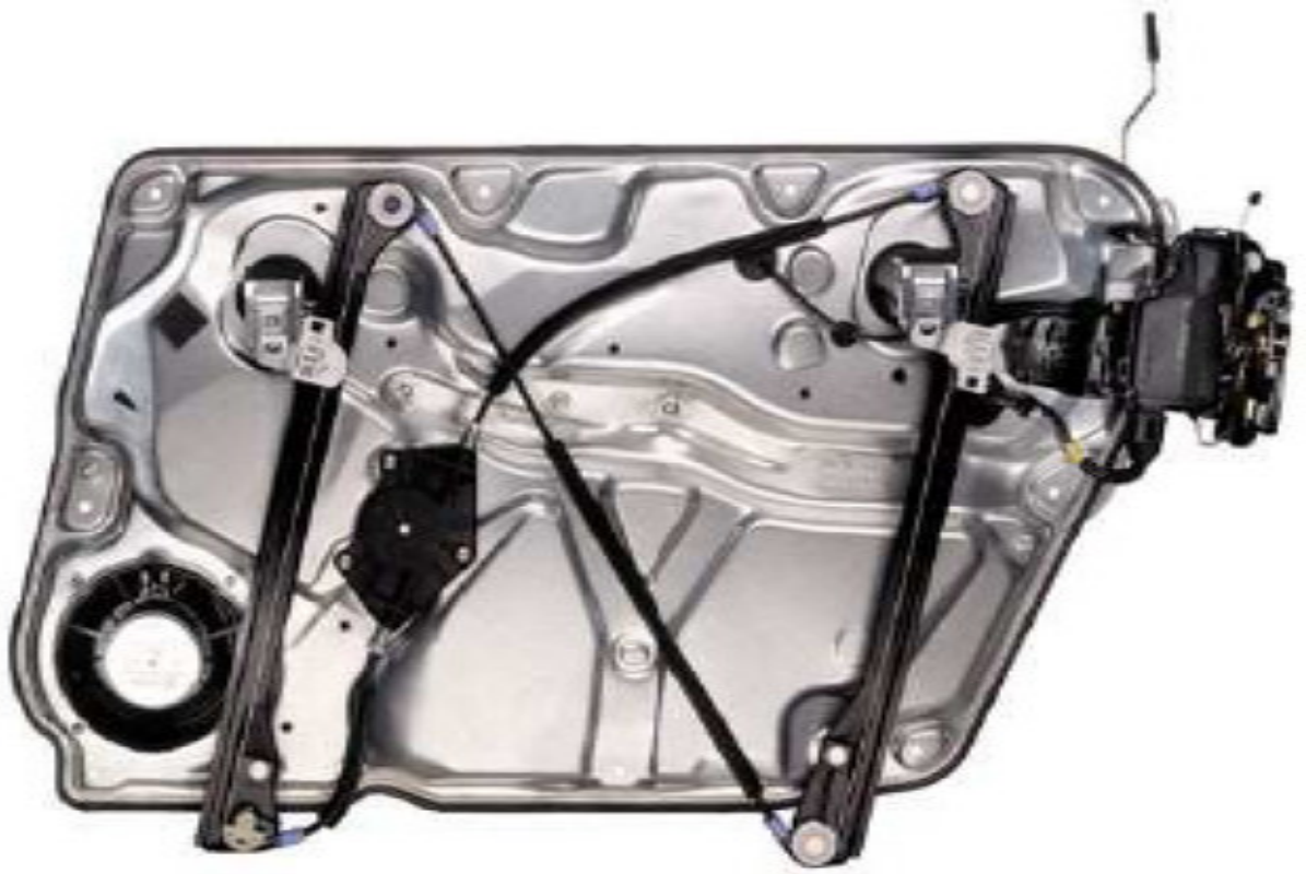
Fig. G.2. Fotografia d'alçavidres doble carril muntat a mòdul
