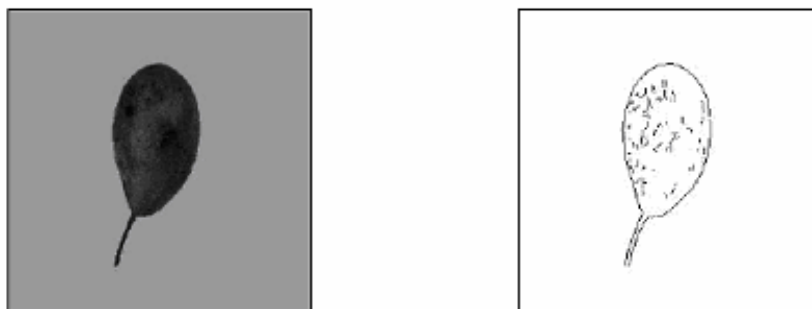
Fig. 2.1 Exemple d'aplicació d'un algoritme de detecció de contorns; a partir d'una imatge (imatge esquerra) obtenim els contorns de la mateixa (imatge dreta)
