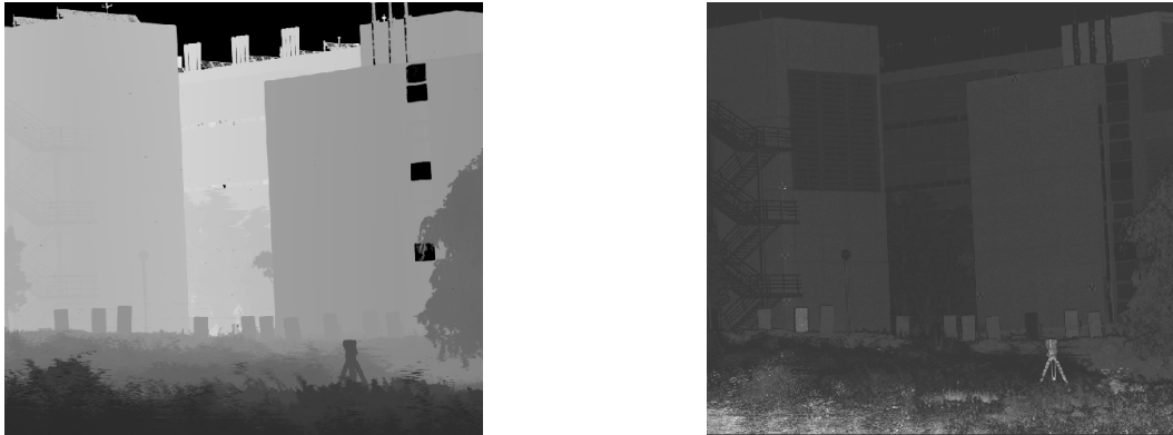
Fig. 2.6 Núvol de punts de distància i d'intensitat, respectivament
