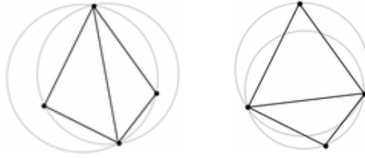
Fig. 4.6 A l'esquerra observem una triangulació que no compleix la condició de Delaunay. A la dreta s'observa el flip de l'aresta comú, el qual produeix una triangulació que sí que compleix la condició de Delaunay
