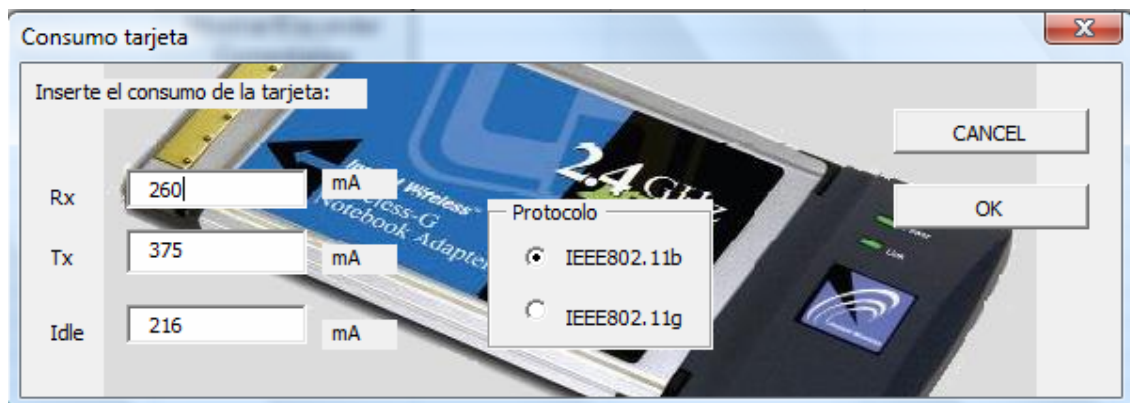
Fig. VI.2. Opción “Insertar valores de la tarjeta WI-FI”
