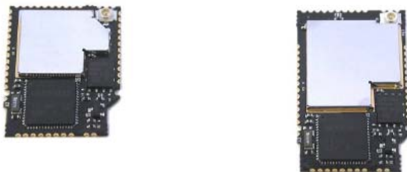
Fig. A.6 Tmote Mini (25,4mm x 20mm) i Mini Plus* (32mm x 20mm)
