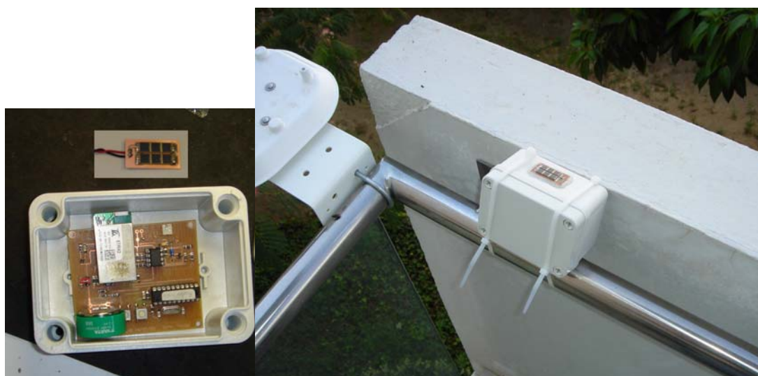
Fig. 4.19 Node encaminador sincronitzat i mecanització a la terrassa de la sala 124P de l'EPSC.
