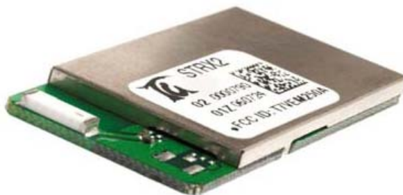
Fig. A.7 ETRX2 (37,75mm x 20,5mm)
