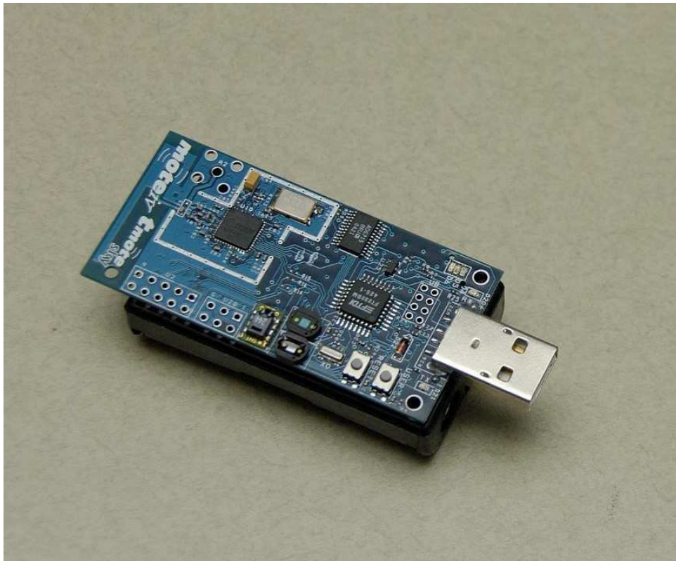
Fig. 1.3 Dispositivo Tmote Sky.
