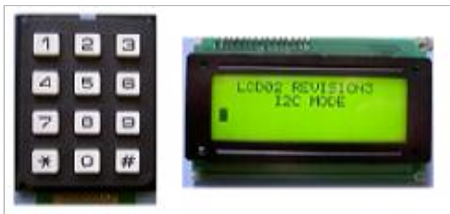
Fig. 2.3. Ejemplo de teclado matricial y pantalla LCD incorporable al AC vía bus I2C.
