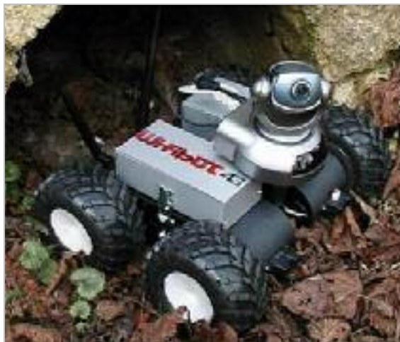
Fig. 2.4. Wifibot, robot desarrollado por 4G Systems y basado en el hardware del MTX-1.
