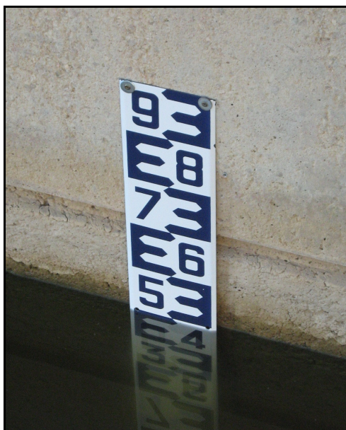
Fig D.2 Limnímetre situat al mur de l'estany del Campus del Baix Llobregat
