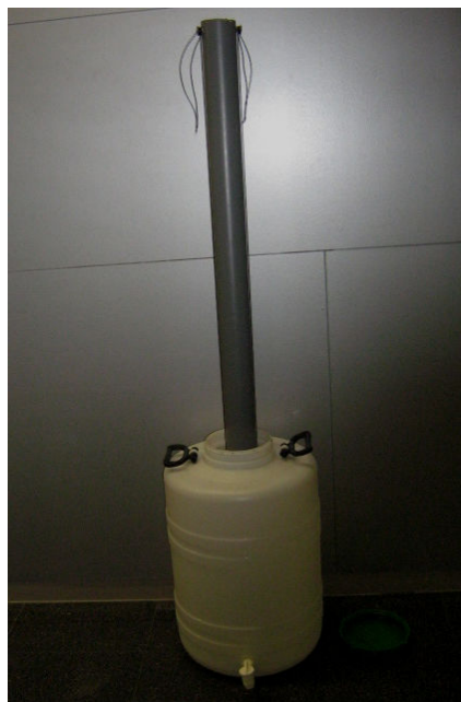
Fig. 1.3 Sensor ubicat dintre del recipient utilitzat per fer les mesures experimentals al laboratori
