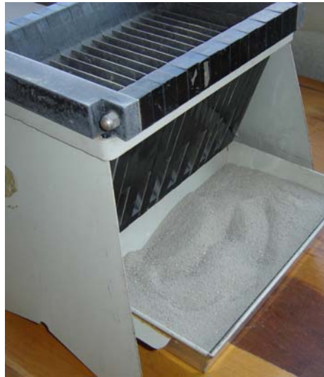
Le quarteur : vue de côté et de dessus, montrant la répartition symétrique du matériau
