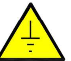
PUESTAS A TIERRA
