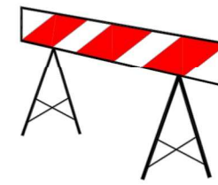
BARRERA METÁLICA DE DESVIACIÓN DEL TRÁFICO
