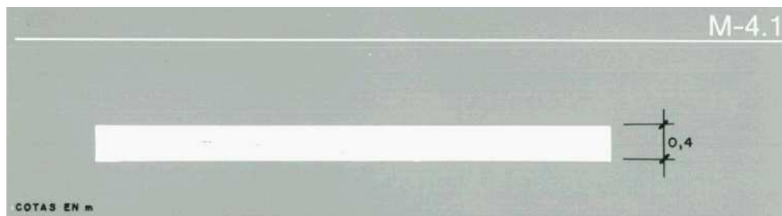
Figura 10.6 Marca vial M-4.1 [Norma 8.2IC Marcas viales]
