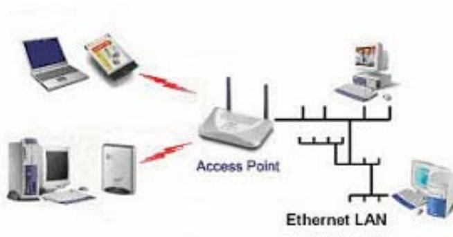
**Fig. 1.3** Ejemplo de comunicación inalámbrica en modo infraestructura
