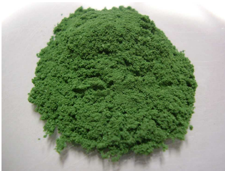
Fig. 6.7. Imatge de la fase verda, Y211, obtinguda mitjançant calcinació a 950°C durant 4 hores.
