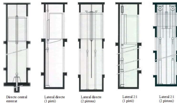
Figura A-27: Diferents opcions de configuració d'un sistema elevador hidràulic.
