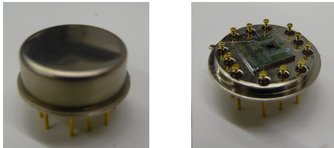
Figura 3.3: Encapsulat utilitzat en els dispositius MEMS termoelèctrics. A l'esquerra, amb el dispositiu MEMS tapat. A la dreta, sense la tapa de protecció.
