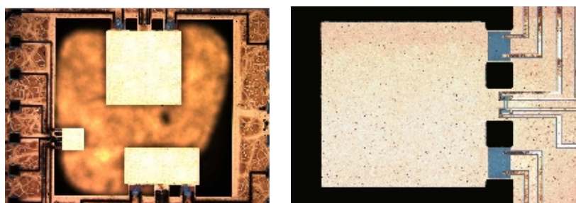
Figura 3.1: Imatges preses amb el microscopi òptic. A l'esquerra, disposició dels ressonadors MEMS de tipus voladís. A la dreta, detall d'un dels ressonadors.
