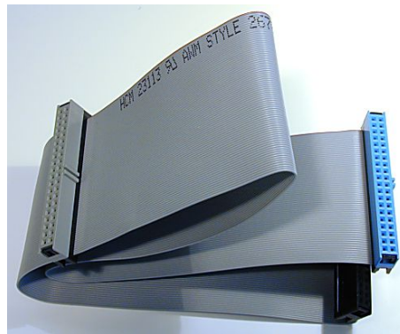
Figura 4.12: Cable UltraDMA emprat en el connexionat entre la part analògica i digital del sistema electrònic
