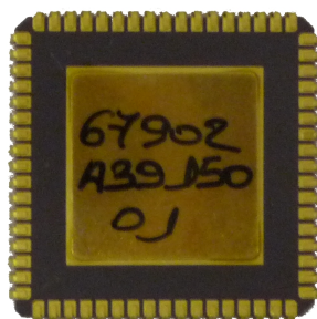
Figura 4.8: Encapsulat del xip d'atac i sensat, dissenyat per Daniel Fernández en la seva tesi doctoral.
