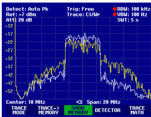
Fig. 4.23. Degradació de l'espectre per una branca un metre més llarga que l'altra.
