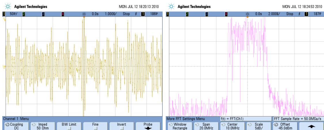
Fig. 4.8. Senyal OFDM en el domini temporal i freqüencial obtingut amb un splitter ZFRSC-42.
