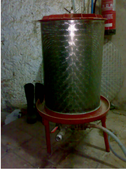
Foto 9. premsa hidro pneumàtica de la marca Speidel Hydro press 90L
