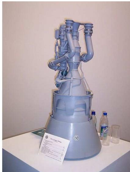
**Fig 1.2** Motor NK-33. Fue un motor de los años 70 creado para un cohete soviético. Es el motor con la relación empuje a peso más alto creado jamás, con un alto impulso específico.
