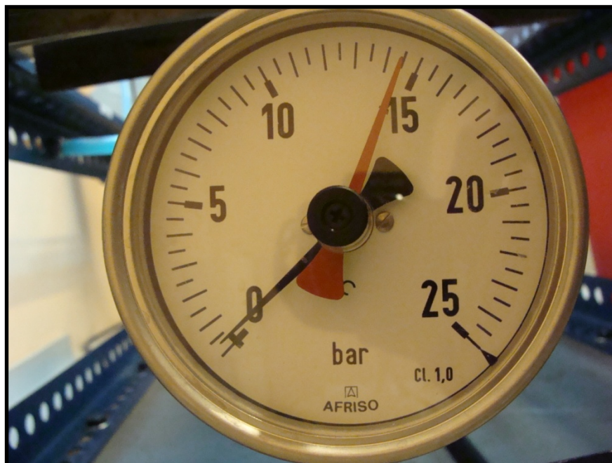
Fig. 41 Detall del manòmetre amb agulla d'arrossegament
