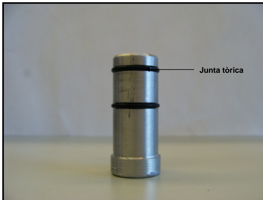
Fig. 55 Detall del nou col·lector d'alumini amb les juntes tòriques
