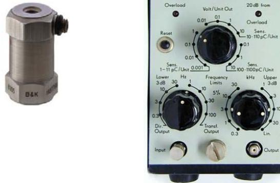
**Figura 5.2. Fotografía del set de calibración patrón, formado por el acelerómetro patrón B&K 8305 (izquierda) y su acondicionador de señal (derecha).**
