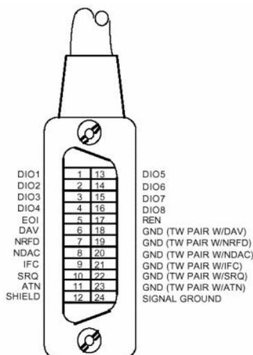
Figura 4.14. Pinout del conector GPIB.
