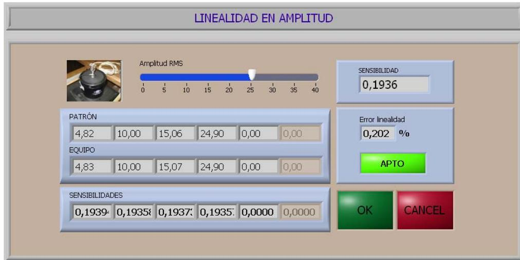
Figura A.3.11. Panel frontal utilizado para controlar el progreso de la calibración de linealidad.
