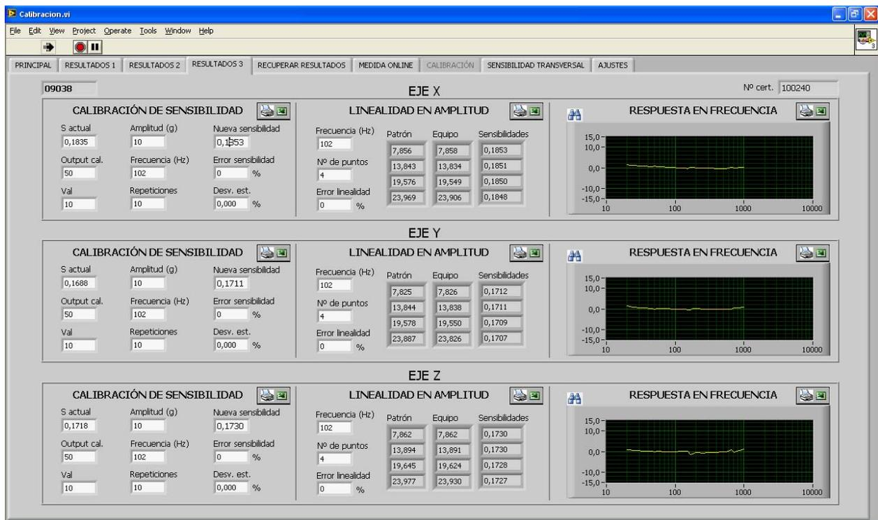
Figura A.2.18. Panel de resultados. En él se van guardando de manera consecutiva los resultados de las calibraciones. El panel Resultados 3 se utiliza también para visualizar los resultados después de recuperarlos.
