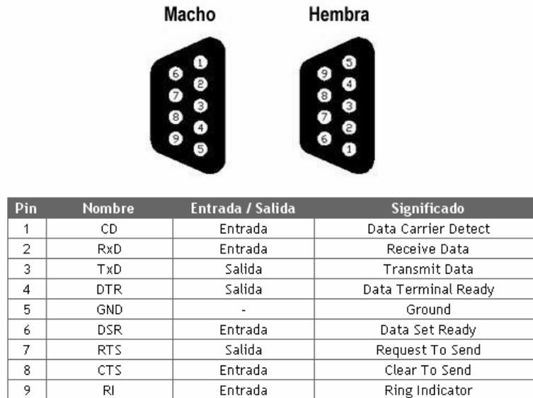
**Figura 4.11. Patillaje de un conector RS232 de 9 pines.**
