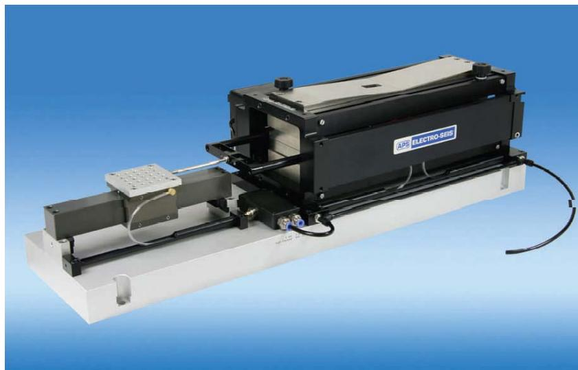
**Figura 3.33.** Foto del vibrador lineal de baja frecuencia y amplio recorrido *Spektra APS500* para la calibración de acelerómetros de baja frecuencia y bajo rango de amplitud
