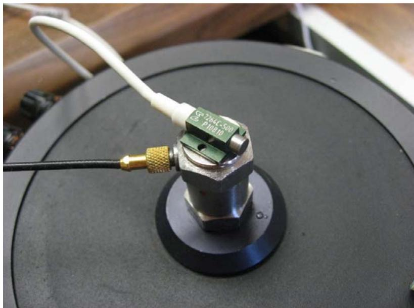
**Figura 8.13. Montaje del UUT (verde) sobre el acelerómetro patrón utilizando adhesivo instantáneo y una base de montaje.**
