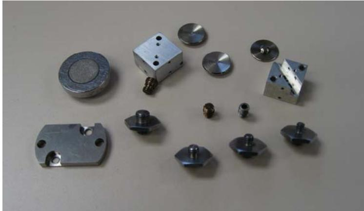
Figura A.2.3. Bases de montaje disponibles en el laboratorio.
