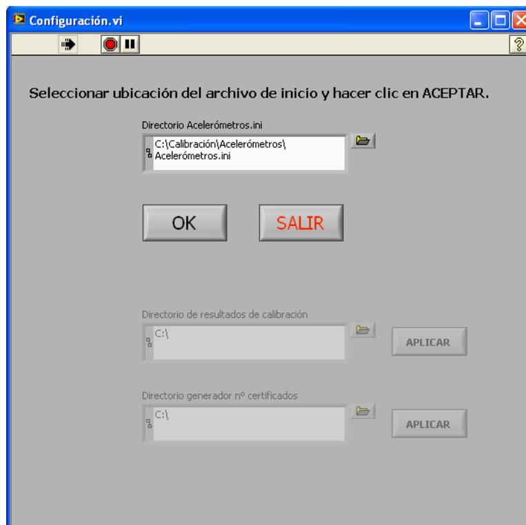
**Figura A.2.2. Panel de configuración durante la instalación de la aplicación. Aquí se configuran los directorios predeterminados donde se guardarán los diferentes archivos de calibración.**
