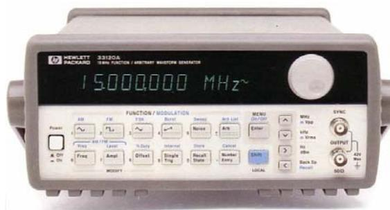
Figura 5.7. Fotografía del generador de funciones Agilent 33120A.
