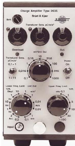
Figura 5.11. Detalle del panel frontal del amplificador de carga para transductores piezoeléctricos B&K modelo 2635
