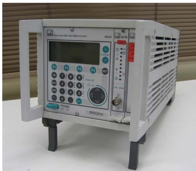
**Figura 5.9. Fotografía del sistema amplificador de medición HBM MGCPlus con las tarjetas ML10B y AP01**
