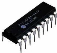
Figura 4.7. Fotografía de un microcontrolador PIC16F84.
