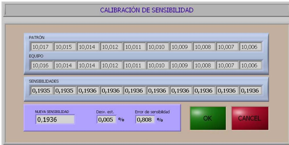
Figura A.3.9. Panel frontal utilizado para controlar el progreso de la calibración de sensibilidad.
