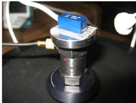
Figura 8.21. Montaje del UUT sobre el acelerómetro patrón.
