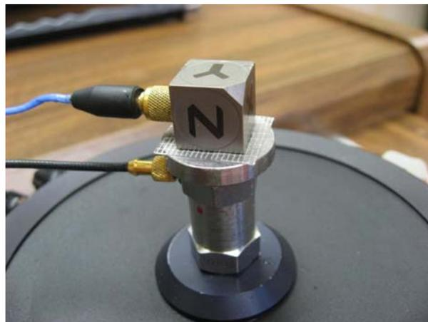
Figura 8.19. Detalle del montaje de un acelerómetro utilizando el método de la cinta adhesiva.
