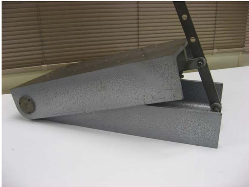
**Figura 3.32.** Foto de una plataforma posicionable para la calibración de acelerómetros de bajo rango y respuesta estática.
