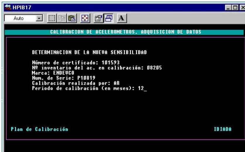
Figura 7.12. Introducción de datos generales de calibración.
