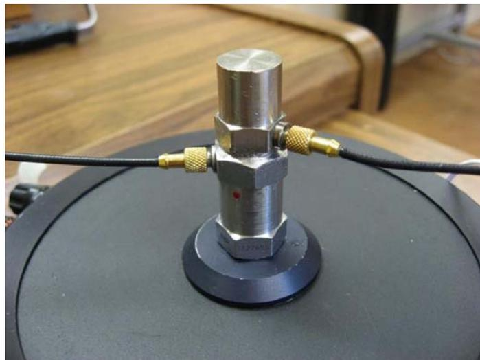
**Figura 8.2. Montaje del acelerómetro piezoeléctrico sobre el acelerómetro patrón.**
