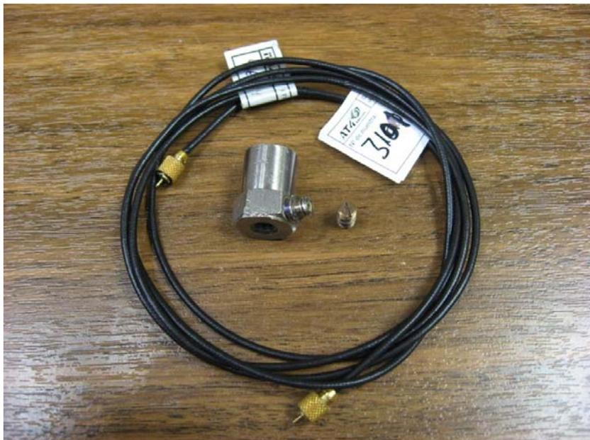
Figura 8.1. Acelerómetro piezoeléctrico B&K 4371 con su cable de señal asociado y el elemento de fijación.
