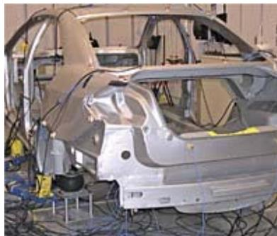
Figura 3.9. Banco de ensayo para análisis de vibraciones en la carrocería de un automóvil.
