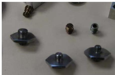
**Figura 8.16.** Ejemplos de elementos de fijación roscados.
