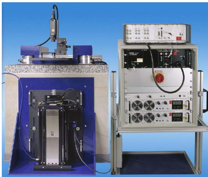
Figura 3.35. Sistema de calibración primario de acelerómetros *SPEKTRA-CS18P* basado en interferómetro láser.
