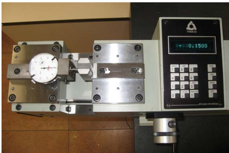
Figura 2.3. Ejemplo de calibración de un reloj comparador. Se compara la lectura del instrumento con un banco de medida de una coordenada horizontal como patrón.
