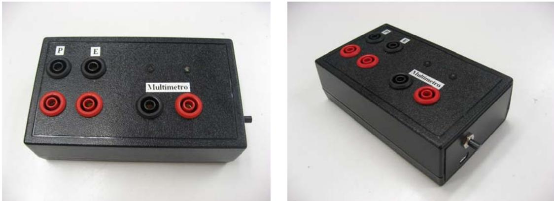
**Figura 7.11. Fotografías de la tarjeta de conmutación una vez finalizada y operativa.**
