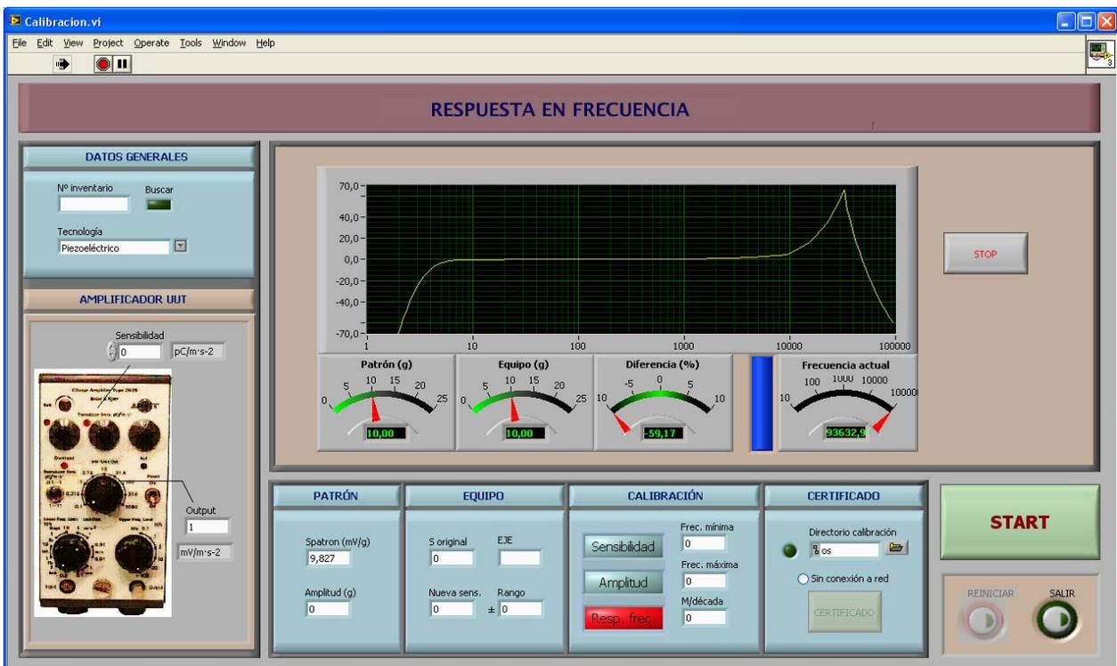
Figura 7.17. Panel frontal de calibración de la segunda versión del programa.
