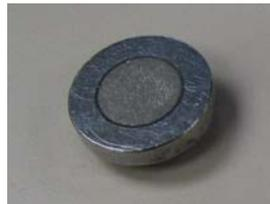
**Figura 8.18. Base de montaje para el uso del método de la cinta de doble cara.**
