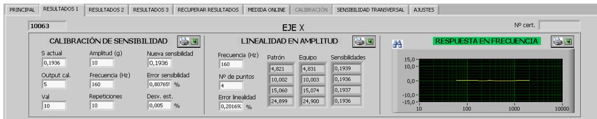
Figura A.3.15. Fragmento del panel frontal utilizado para visualizar los resultados de la calibración.
