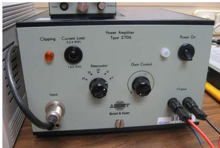
Figura 5.5. Fotografía del amplificador de potencia para la excitación eléctrica del vibrador electrodinámico.
