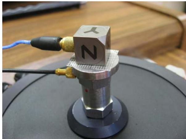
Figura A.2.4. Ejemplo de montaje de un acelerómetro utilizando cinta de doble cara
