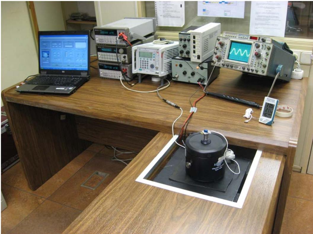
Figura 5.1. Banco de calibración de acelerómetros.
