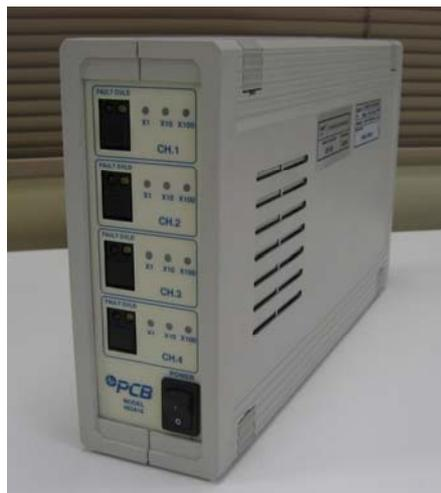
**Figura 5.12. Fotografía del acondicionador de señal para transductores IEPE.**
