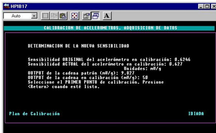
Figura 7.13. Introducción de parámetros de configuración de calibración.
