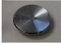
**Figura 8.17. Base de montaje para el uso del método del adhesivo instantáneo.**
