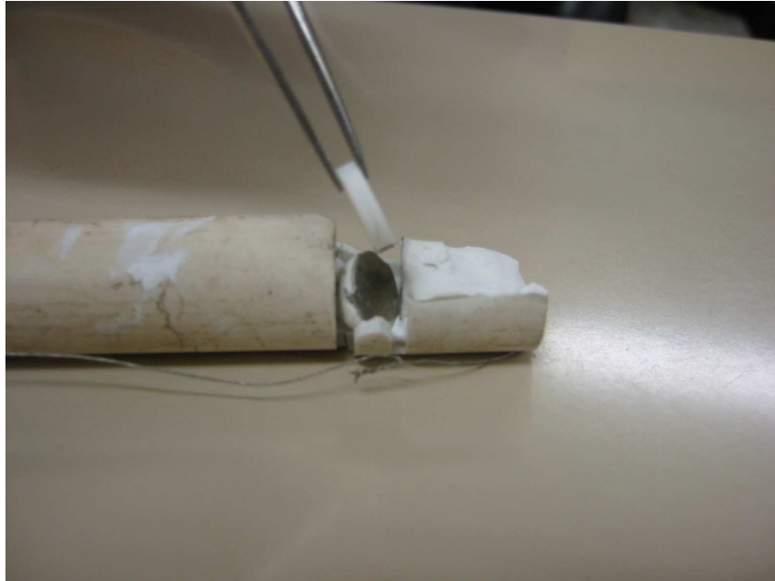
Fig. An1.4. Colocación de la muestra entre láminas de platino
