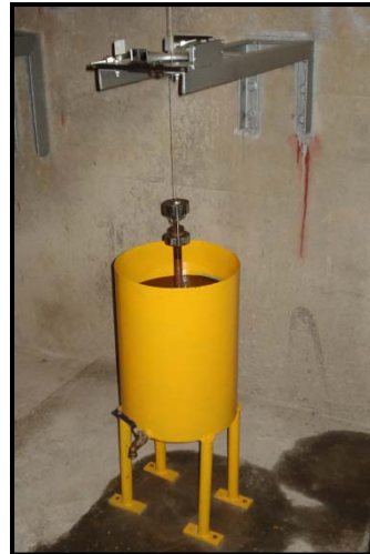
Figura 3.6- Péndulo indirecto de la presa de la Baells
