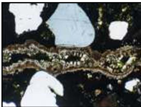
Figura 2.6- Brucita con fisuras en microscopio (Garcés et al., 2007)
