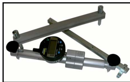
Figura 3.3- Defómetro usado para control de juntas
