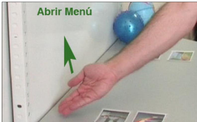
**Figura 3.7.** Abrir menú. Movimiento dinámico. Aparición de la mano por la parte inferior para ir ascendiendo hasta su salida por la parte superior.
