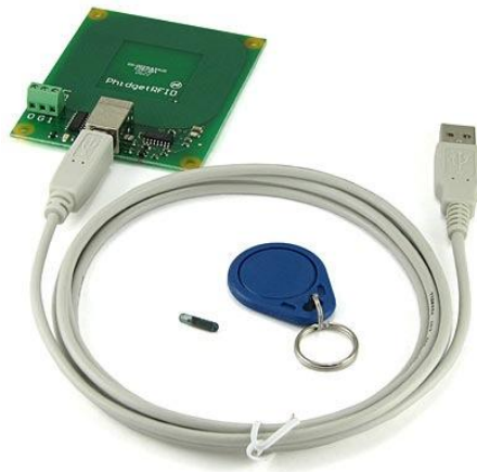
figura 1. Un lector i dos tags RFID de diferents formes.
