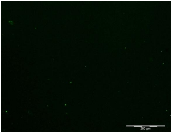
Titanio limpio sumergido durante 5 h en la solución de péptido-carbonato de sodio a 10 aumentos.
