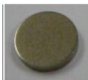
Figura 3.3.- Muestra de titanio sometida a la reacción de piraña.
