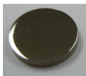
Figura 3.1.- Muestra de titanio pulida hasta efecto espejo.
