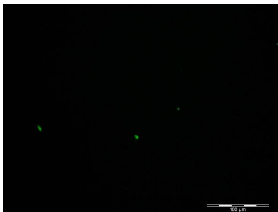
Titanio limpio sumergido durante 1 h en la solución de péptido-carbonato de sodio a 20 aumentos.
