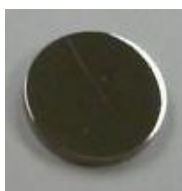
Figura 3.2.- Muestra de titanio sometida al proceso de plasma cleaning.
