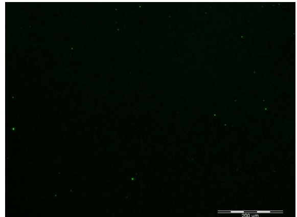
Ti limpio sumergido durante toda la noche en la solución de péptido-carbonato de sodio a 40 aumentos.
