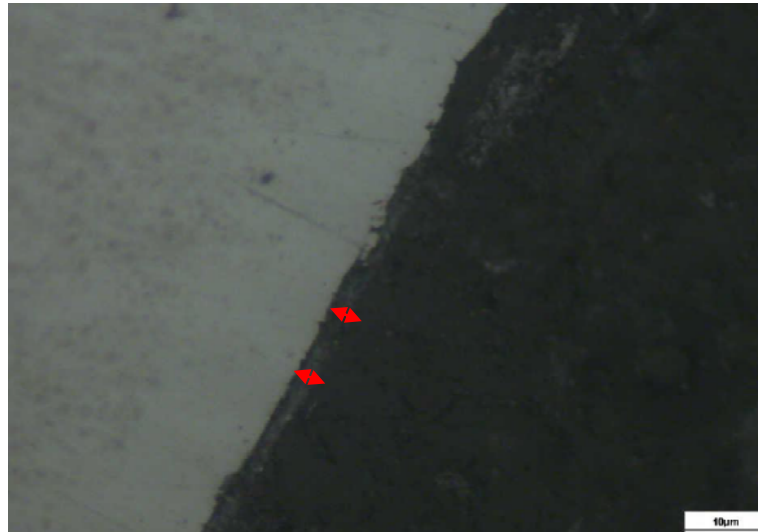
Fig 3.11 : Probeta de una capa que sufre el tratamiento térmico a 725°C
