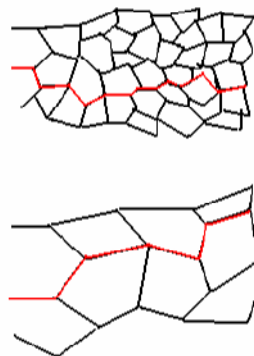
Fig 1.6 : Recorrido de una grieta dentro de un material con tamaño de grano pequeño y grande
