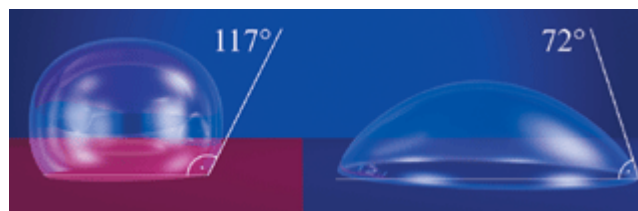
Fig3.25. Izquierda: Material hidrófobo, Derecha: Material hidrófilo
