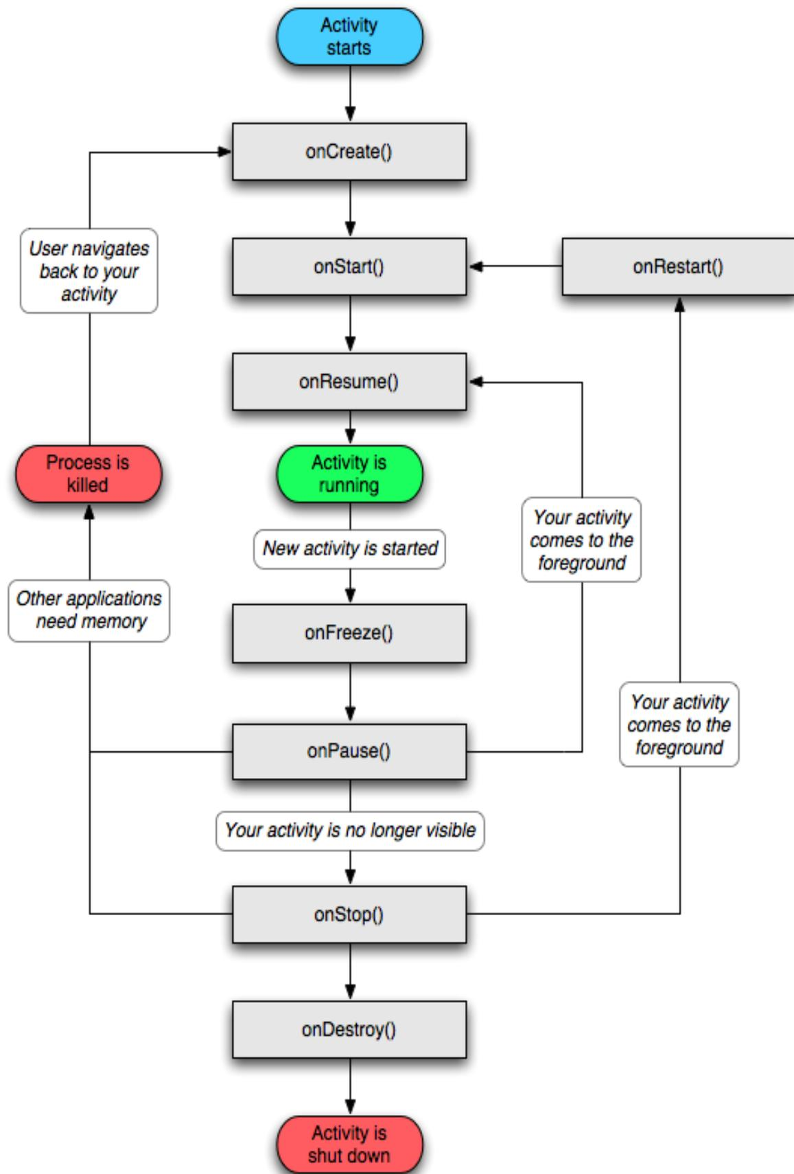
Fig. 1.2 Esquema del ciclo de vida de una Activity.
