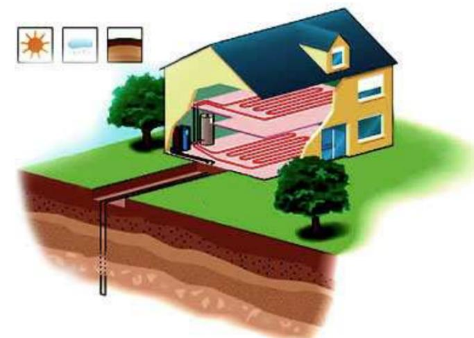
**Calefacción geotérmica mediante sondas de captación verticales**
