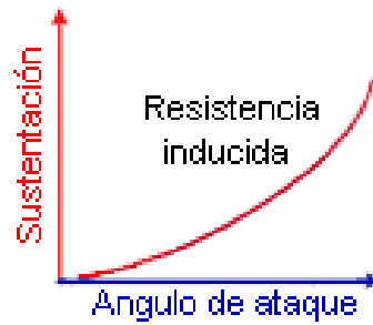
Fig. 1.12 Resistència induïda en funció de l'angle d'atac
