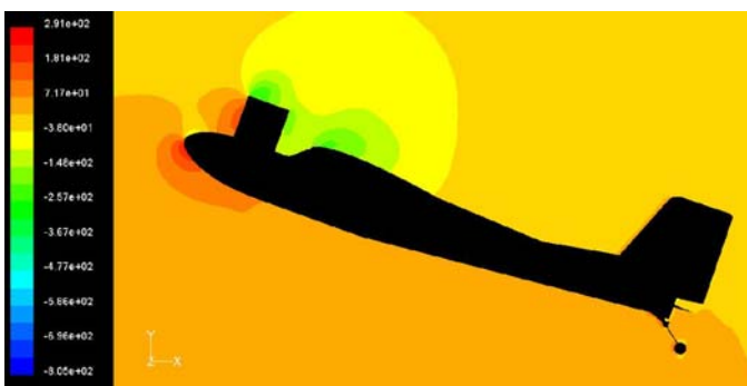
Figura 3.31 Pressió de l'aire al voltant de l'UAV, al pla de simetria
