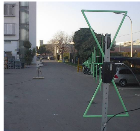
Fig. 4.9 Medida antena patrón a 20 metros
