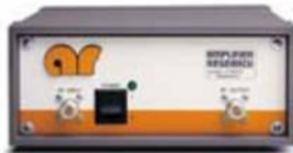
Fig. 9.7 Amplificador de potencia 1W1000B de 100KHz-1000 MHz
