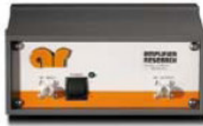
Fig. 9.8 Amplificador de potencia 1S1G4A de 0,8-4,2 GHz
