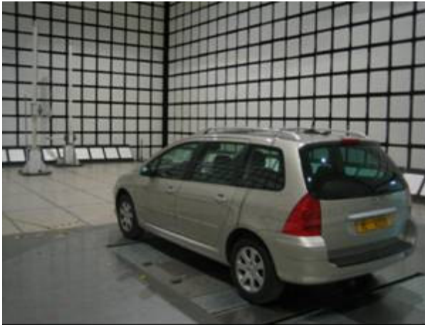
Fig. 6.2. Cámara semi-anecoica y antena transmisora
