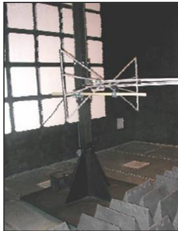
Fig. 9.2 Mástil automático antena transmisora
