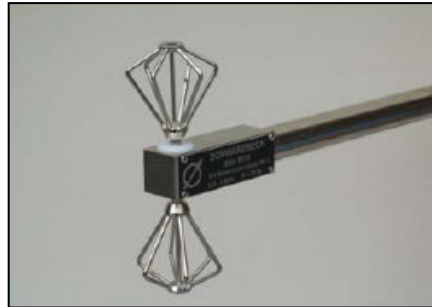
Fig. 9.6 Antena receptora 500-3000 MHz
