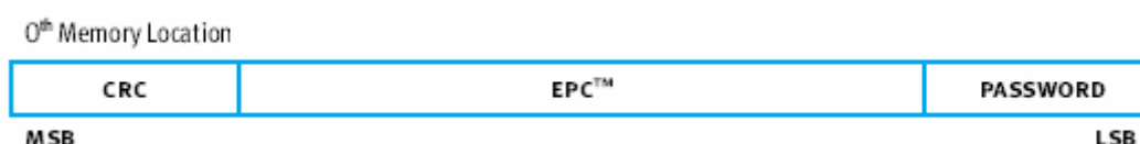
Figura 3.2 Contenido y organización de la Memoria de la Tarjeta Identificadota (ITM).
