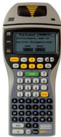
Figura 2.5 Lector de mano de corto alcance que trabaja a la frecuencia de 900MHz
