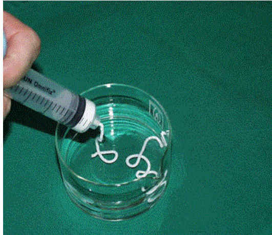
Figura c.8.- Inyectabilidad del Calcibon.
