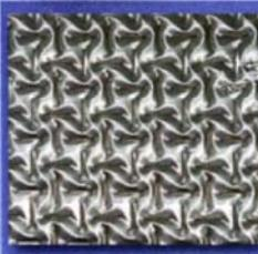
Utiliza el revolucionario absorbedor DTE (Directa Transferencia de Energía), patentado por Soleco, realizado mediante dos planchas de acero inoxidable de 0.6 mm soldadas por láser y conformadas por presión (hidroforming). Toda la superficie absorbadora está en contacto directo con el fluido caloportador.
