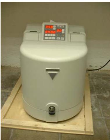
Fotografía 1: Molino planetario de bolas en funcionamiento (FRITSCH Pulverisette 6).
