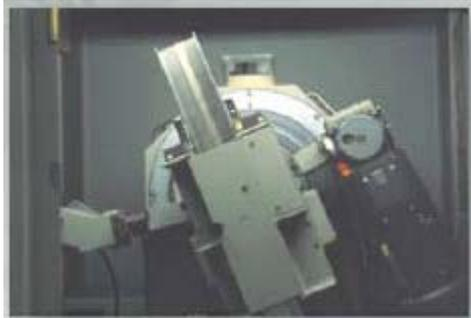
Fotografía 7: Difractómetro de polvo Siemens D-500 (S1) con cargador automático de muestras.
