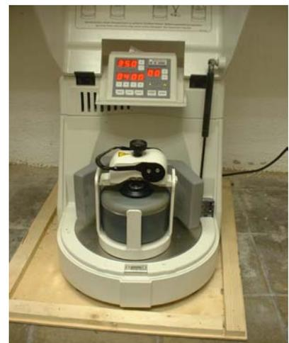
Fotografía 2: Molino planetario de bolas abierto (FRITSCH Pulverisette 6).
