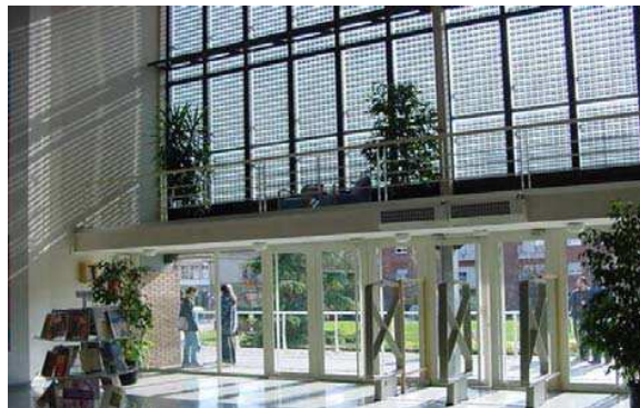
INTEGRADO-CERRAMIENTO: FACHADA SEMITRANSARENTE.
