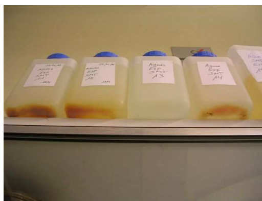
Figura 76. Posos de hierro resultantes del tratamiento Foto-Fenton
