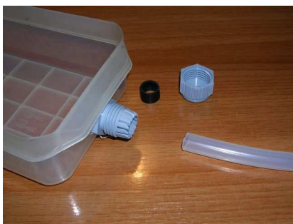
Figura 85a. Construcción del reactor.
