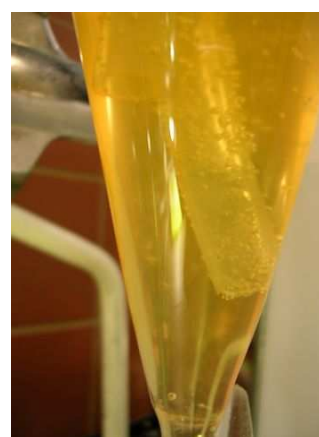
Figura 85d. Detalle del sistema de adición del peróxido de hidrógeno.
