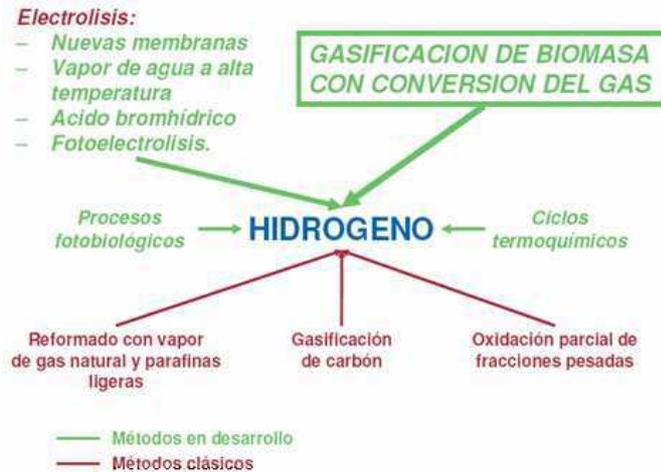
**Fig. 3.12.** Métodos de producción de hidrógeno. (Fuente: Grupo de Ingeniería Química. URJC)
