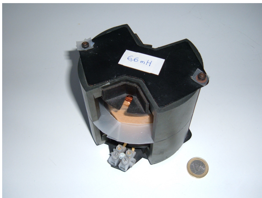
Figura I.6 Bobina utilitzada en el rectificador monofàsic L=6.6\text{mH}
