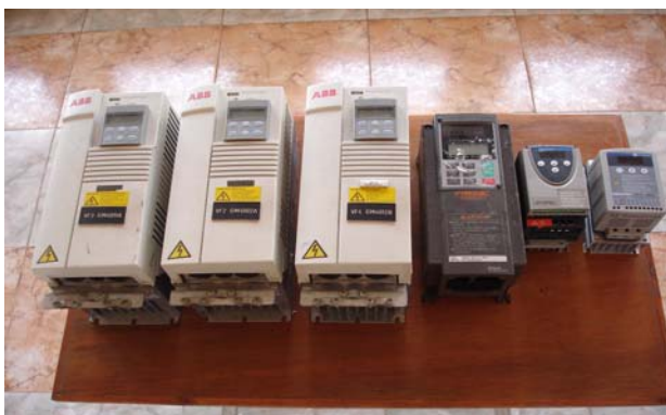
Fig. 5.29 Variadors de freqüència utilitzats
