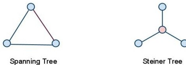
Fig. 3.3 Exemplificació de xarxa amb Spanning Tree, a la esquerra, i la de Steiner Tree a la dreta.
