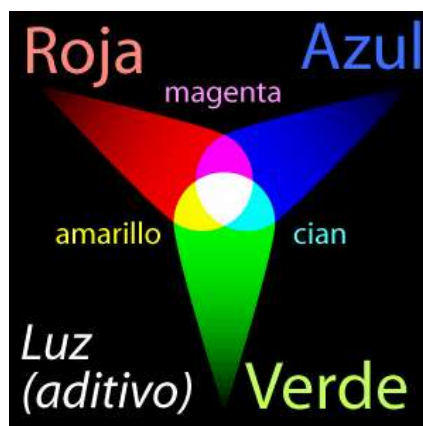
Figura 1 ( http://www.glosariografico.com/mezcla_aditiva ): mezclas aditivas.
