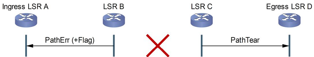
Figura 4.10: Notificación de errores con *Path State Removed Flag*
