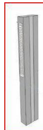
Figura G.2.Obertura de pas lateral sobre carpinteries de PVC
