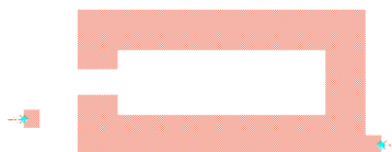
Fig. 3.15 Punto de enganche de la línea de salida con el resonador 5
