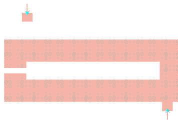
Fig. 4.12 Punto de enganche de la línea de entrada con el resonador 0
