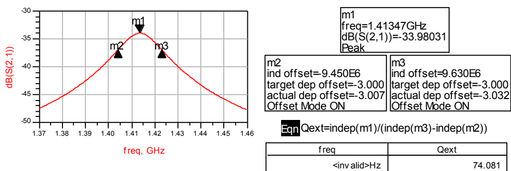
Fig. 2.10 Cálculo del factor de calidad externo del prototipo ideal paso banda
