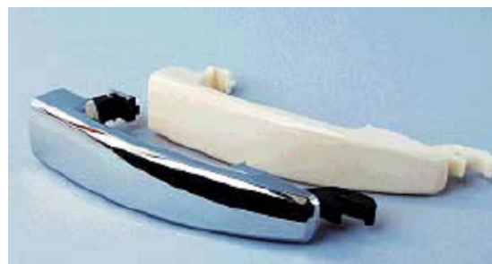
Figura XVII Piezas inyectadas con piel aditivada y con color.
