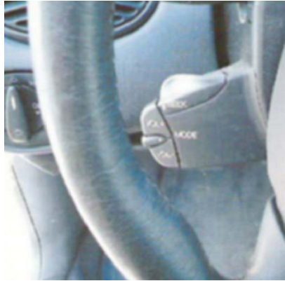
Figura XIV Componente inyectado con piel blanda y núcleo rígid.
