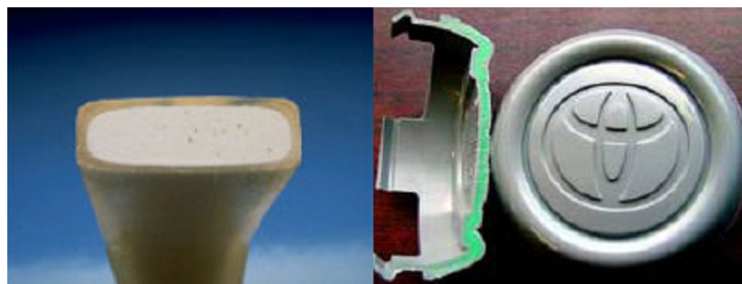
Figura V Piezas inyectadas por co-inyección.
