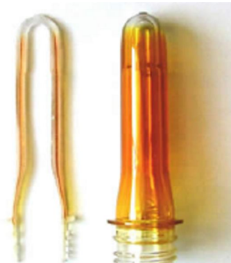
Figura XIX Piezas con núcleo con aditivo y piel virgen.
