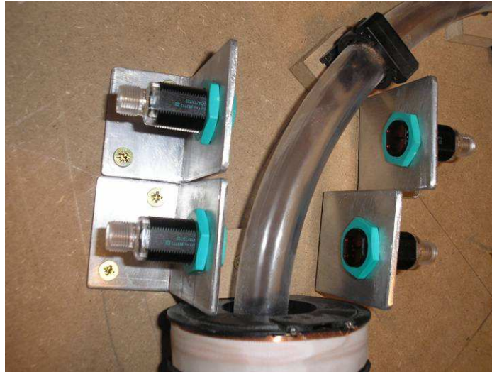
Figura 3.3.1.1. Detalle de la construcción de la maqueta, pareja de sensores
