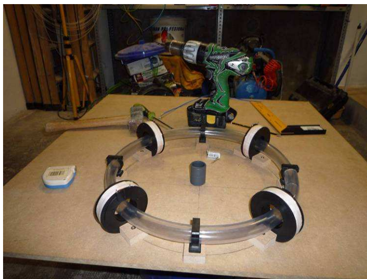
Figura 3.3.2.1. Detalle de la construcción de la maqueta, ubicación bobinas
